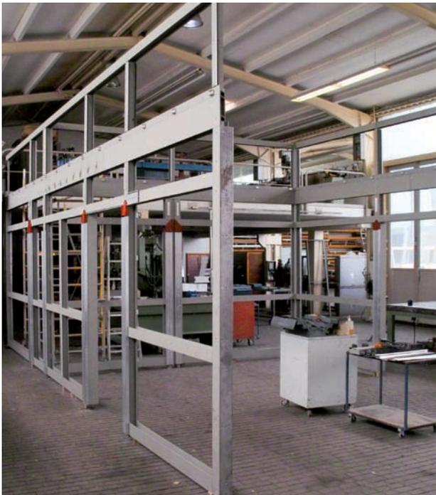
Bei Hereth werden die Systeme zunächst in der Fertigungshalle zusammengebaut, „damit vor Ort dann auch alles genau passt“.
